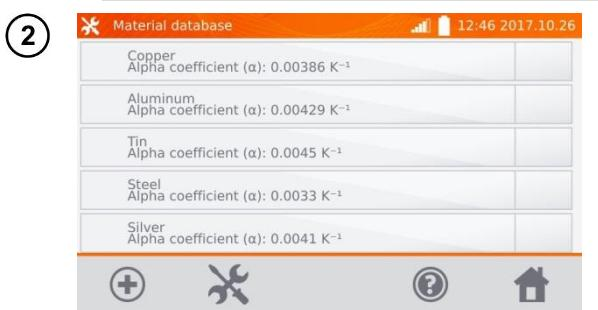
Im Messgerät sind standardmäßig 5 Materialien und deren Widerstandstemperaturkoeffiziente n im Speicher hinterlegt: Kupfer, Aluminium, Zinn, Stahl und Silber. Mit fügen Sie einen neuen Materialsatz hinzu.
